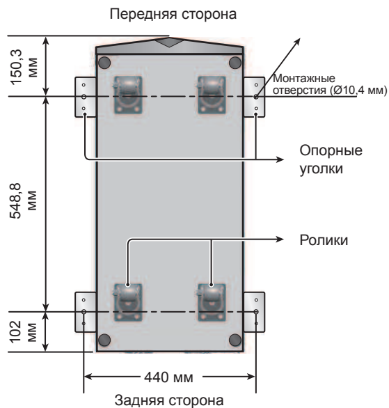
Рис. 6-2. Расположение крепежных отверстий
