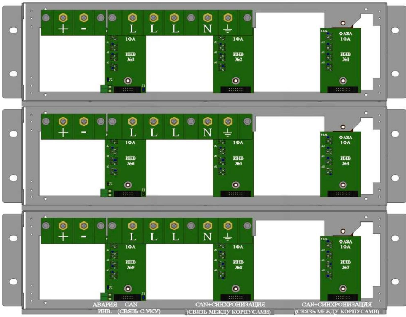
**ПРИЛОЖЕНИЕ 8. ПОДКЛЮЧЕНИЕ СИЛОВЫХ И СИГНАЛЬНЫХ КАБЕЛЕЙ НА
