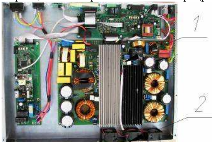
1 – место крепление провода вентилятора, 2 – место присоединения саморезов
