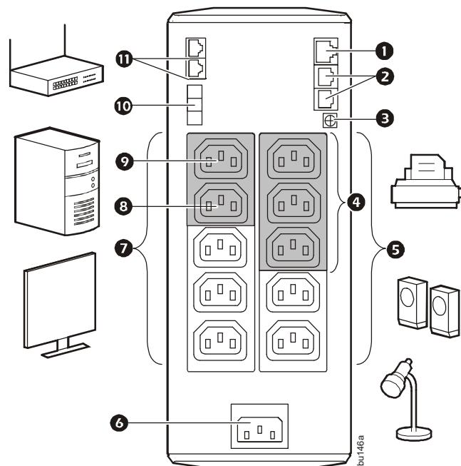
К главному выходу подключайте главное устройство (например, персональный компьютер или аудио-/видеоприемник). К управляемым выходам подключайте периферийные устройства, например принтер, колонки или сканер.
