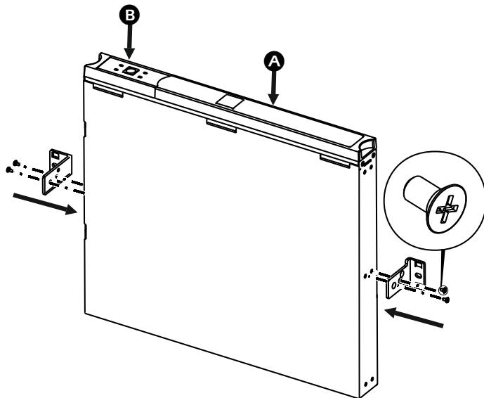
❷ **Примечание:** По возможности, прикрепляйте двумя винтами в стойку стены. Если невозможно закрепить с помощью винтов, используйте расширительные анкера. Крепеж не входит в комплект поставки; рекомендуется использовать шурупы с квадратной головкой под ключ 0,25 inch x 2 inch.
