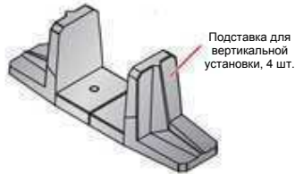
Рисунок 6-3. Сборка подставок для вертикальной установки ИБП 5/ 6/ 8/ 10 кВА
