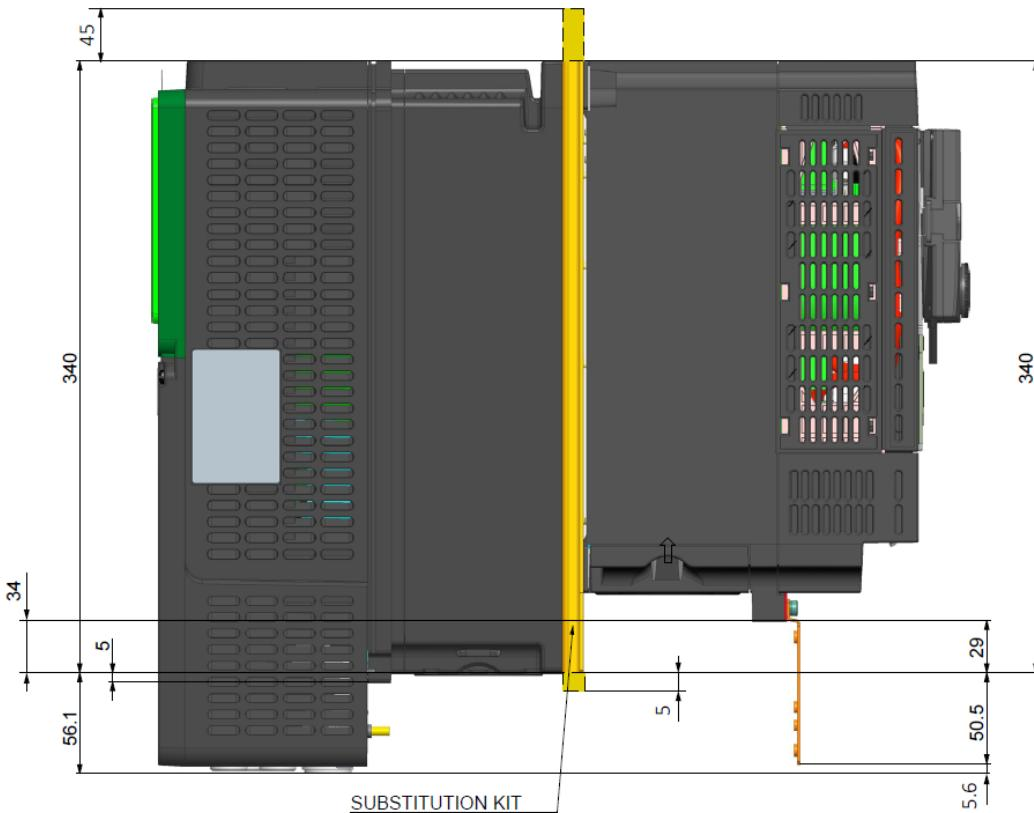
С [VW3A93116](#) (От ATV61/71 типоразмера 5В до ATV630/930 типоразмера 3)
