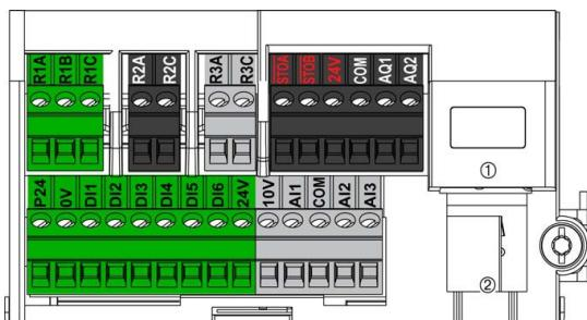
① Ethernet Modbus TCP, ② Modbus
