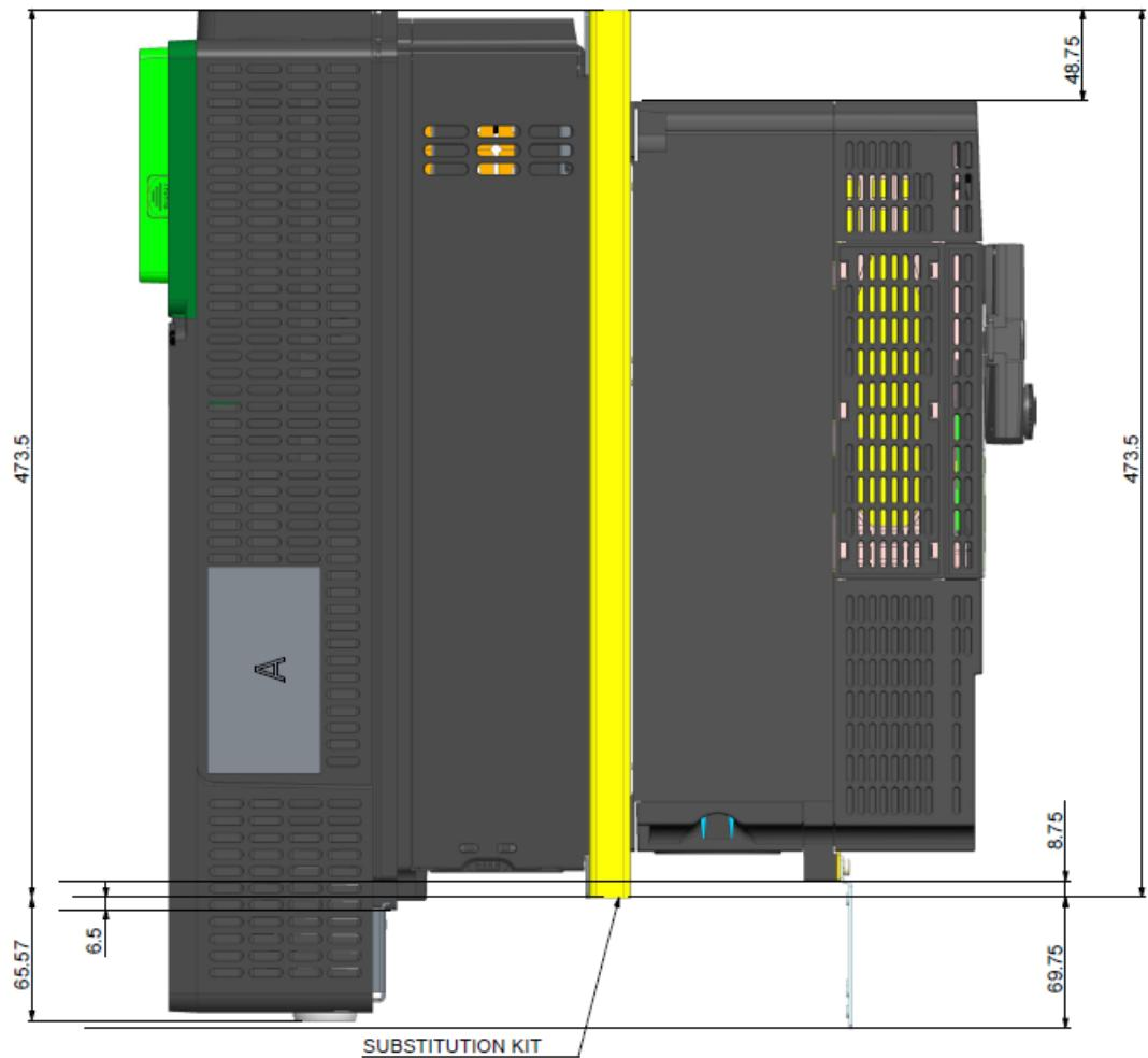
C [VW3A93116](#) (От ATV61/71 типоразмера 6 до ATV630/930 типоразмера 3)
