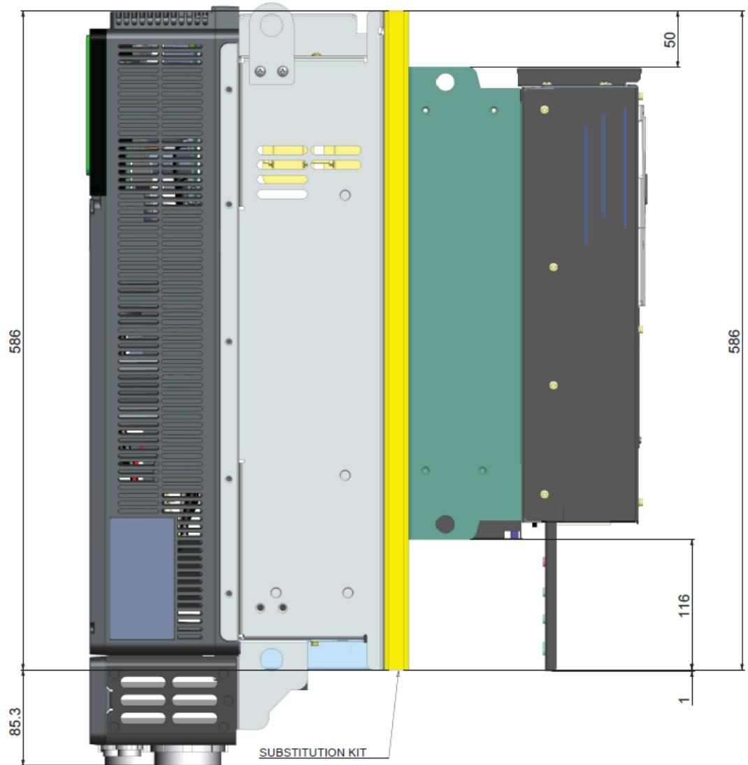
С [VW3A93118](#) (От ATV61/71 типоразмера 8 до ATV630/930 типоразмера 4)
