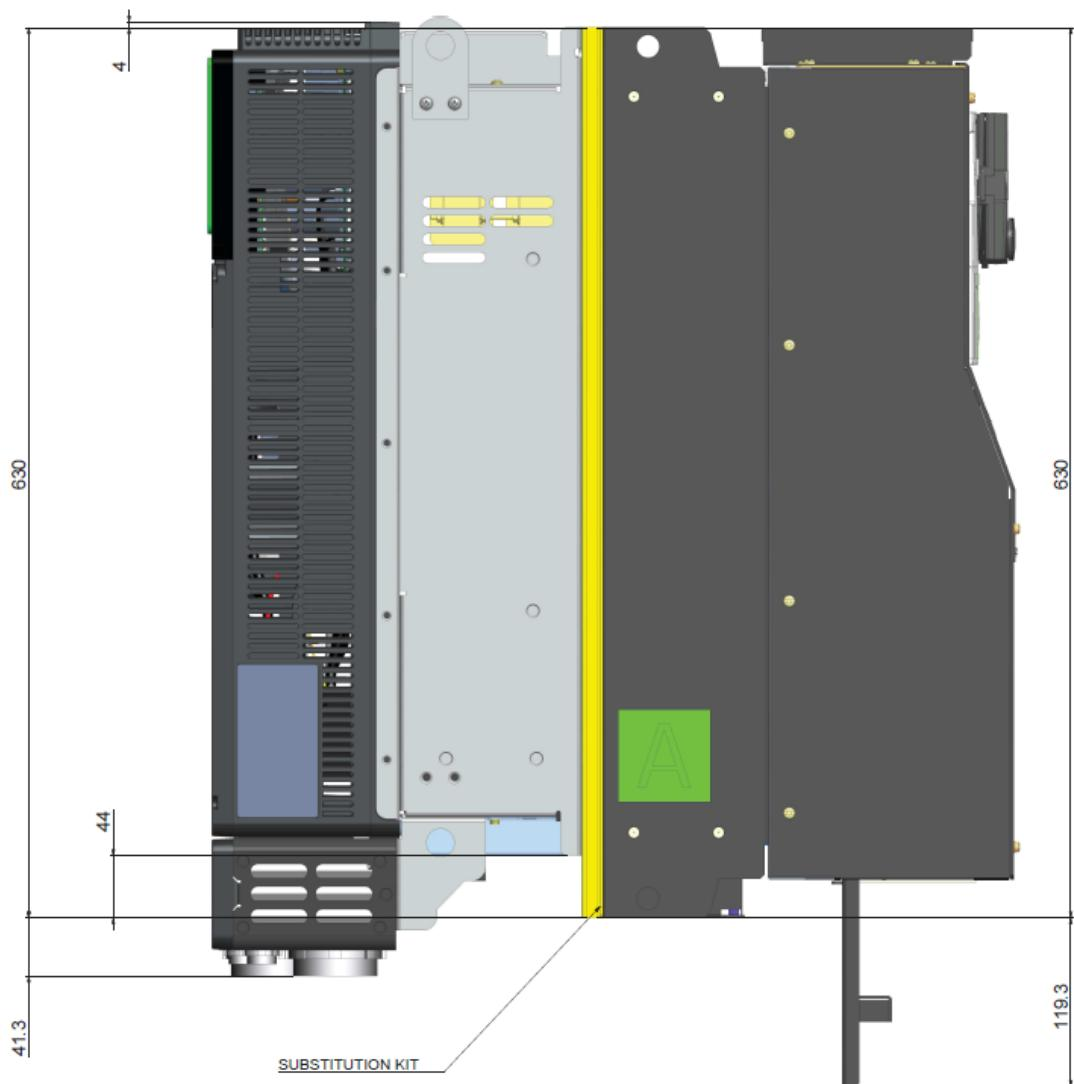
C [VW3A93119](#) (От ATV61/71 типоразмера 8 до ATV630/930 типоразмера 5)
