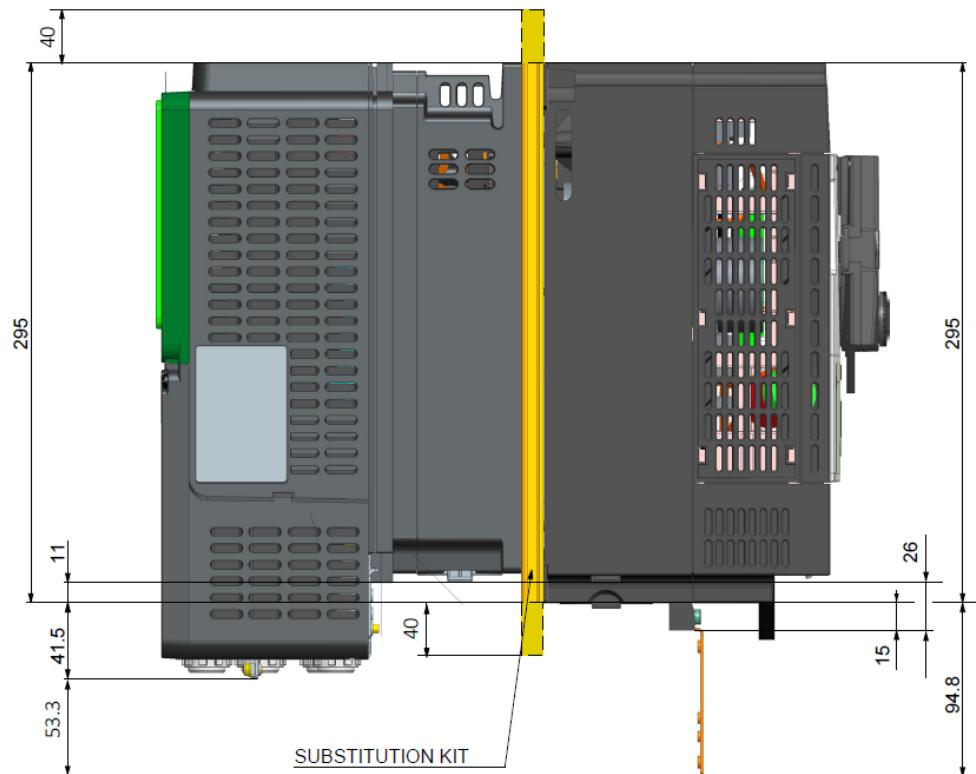
C [VW3A93114](#) (От ATV61/71 типоразмера 4 до ATV630/930 типоразмера 2)
