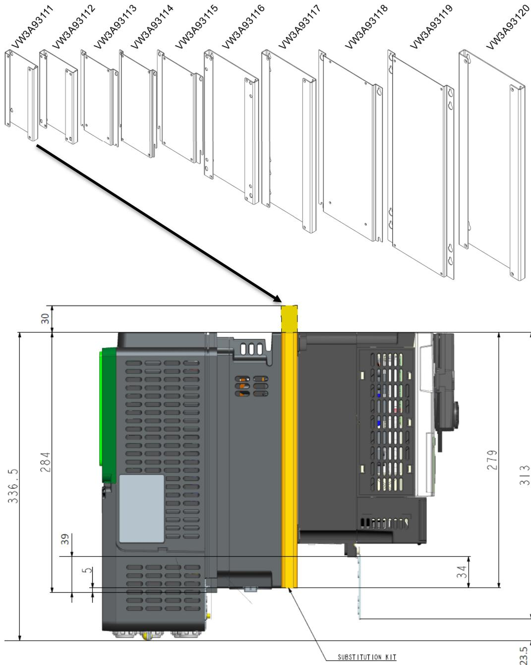
С [VW3A93112](#) (От ATV61/71 типоразмера 3 до ATV630/930 типоразмера 1)
