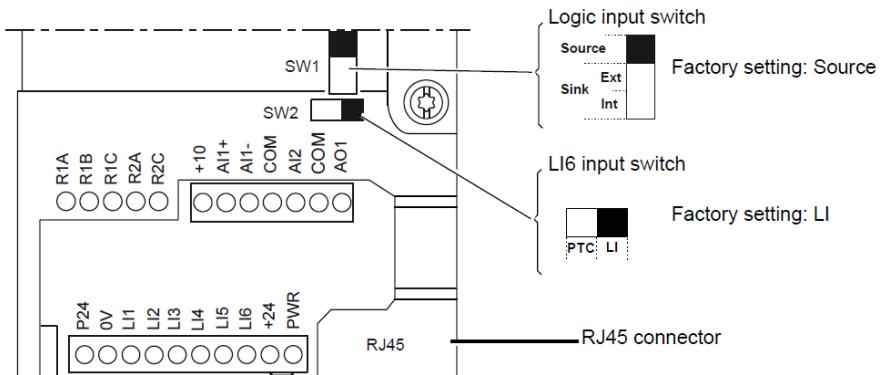
**ПРИМЕЧАНИЕ:** ATV61/71 оснащены перемычкой между клеммами PWR и +24.
