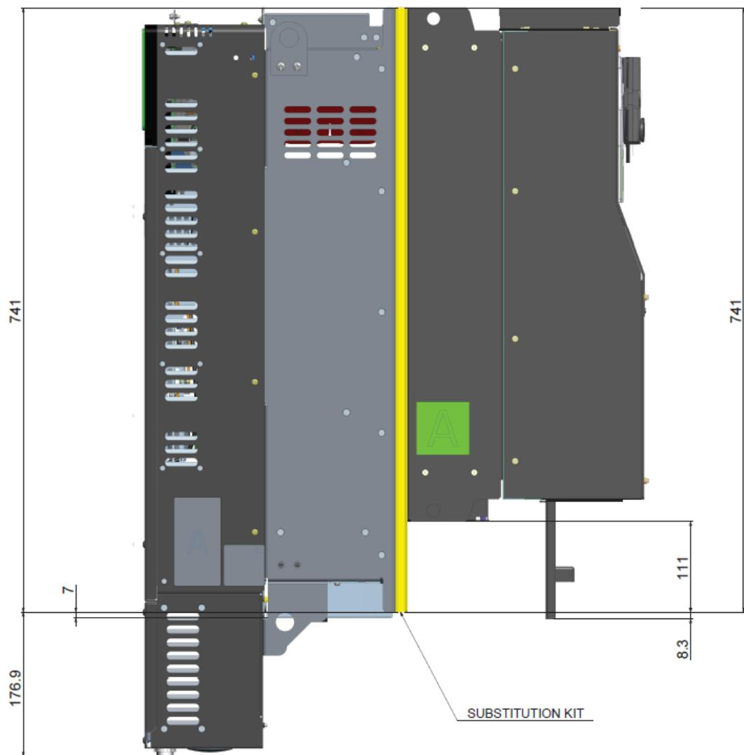
С [VW3A93119](#) (От ATV61/71 типоразмера 9 до ATV630/930 типоразмера 5)
