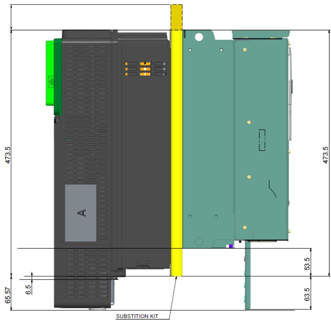
С [VW3A93117](#) (От ATV61/71 типоразмера 6 до ATV630/930 типоразмера 4)
