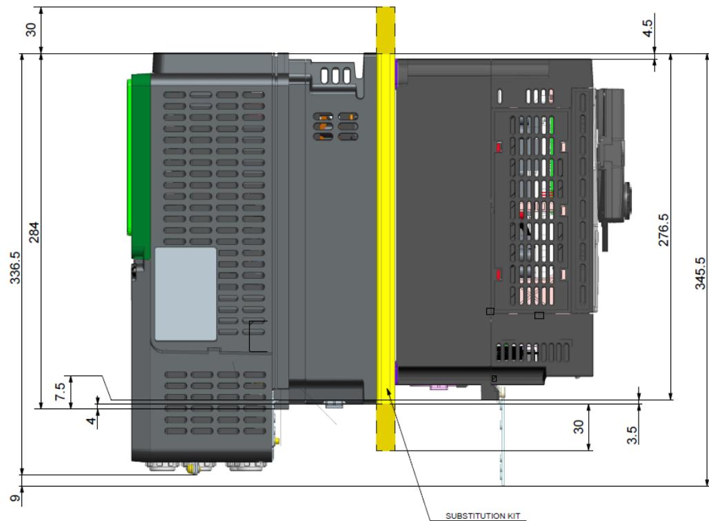
С [VW3A93113](#) (От ATV61/71 типоразмера 4 до ATV630/930 типоразмера 1)
