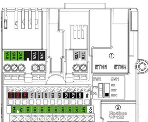
① Ethernet Modbus TCP, ② Modbus
