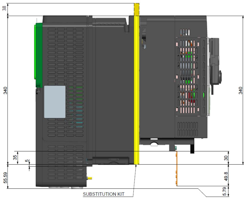
C [VW3A93115](#) (От ATV61/71 типоразмера 5A до ATV630/930 типоразмера 2)
