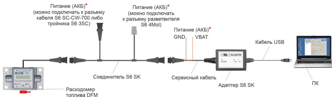
а) подключение DFM AK/A232/A485/ACAN/CK/C232/C485/CCAN/DK/D232/D485/DCAN с помощью S6 SK
