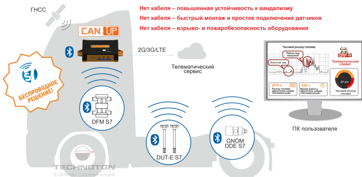
б) беспроводной мониторинг параметров работы автомобиля по Технологии S7
