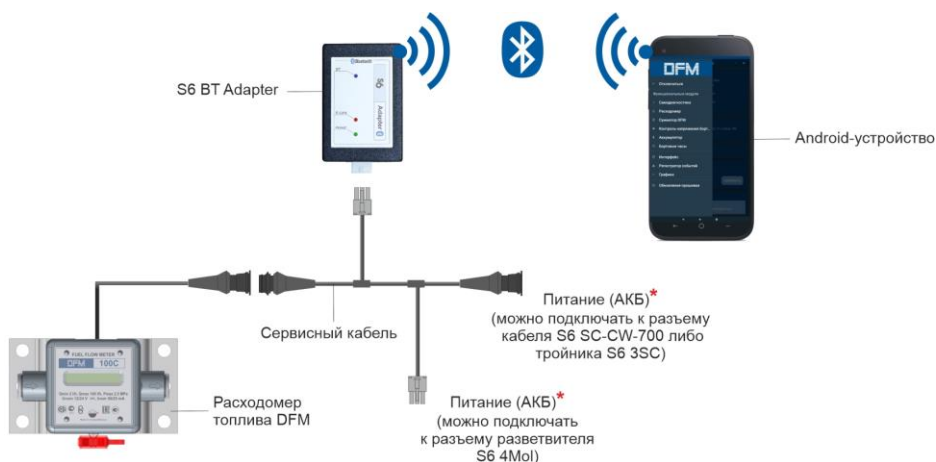
а) подключение DFM АК/A232/A485/ACAN/CK/C232/C485/CCAN/DK/D232/D485/DCAN с помощью S6 BT Adapter
