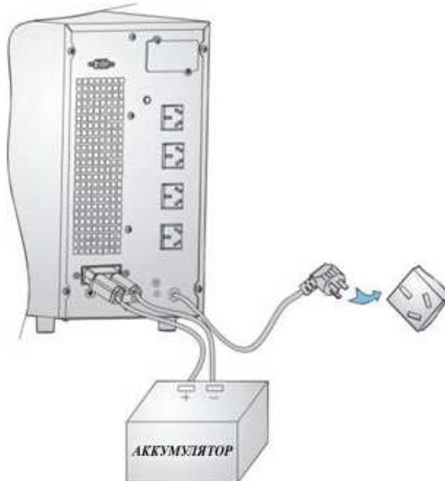
Рисунок 3.3 - Схема подключения аккумуляторов для моделей с увеличенным временем автономной работы
