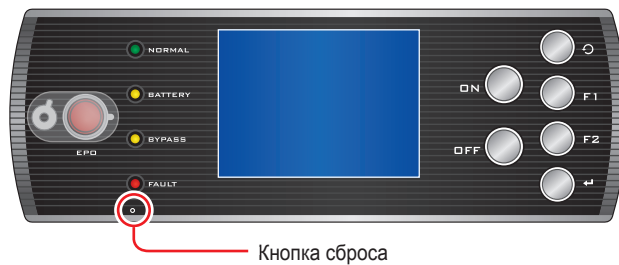
Рис. 8-2. Сброс информации на ЖК-дисплее
