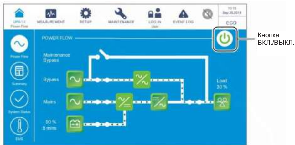
Рисунок 6-52: Экран ECO-режима и кнопка ВКЛ./ ВЫКЛ.
