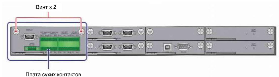
Рисунок 4-5: Расположение платы сухих контактов
