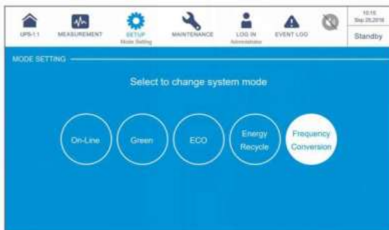
Рисунок 6-30: Выбор режима преобразования частоты
