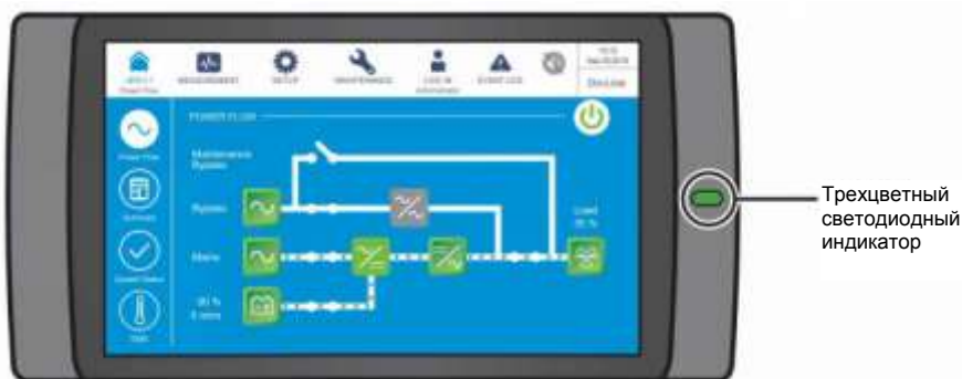
Рисунок 2-11: Расположение трехцветного светодиодного индикатора
