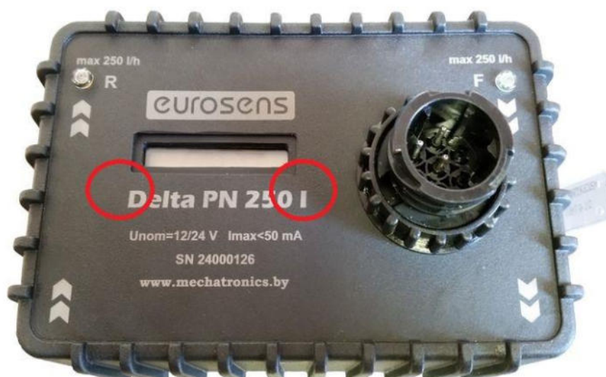
Рис. 2.6. зоны срабатывания магнитного ключа Delta
