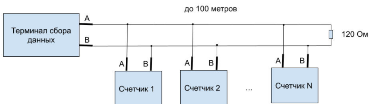
рис. 4.23. Подключение типа “шина”
