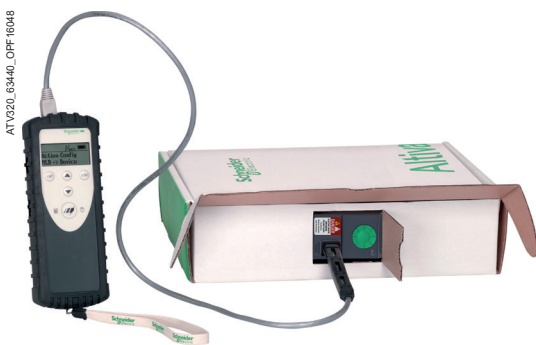
Конфигурирование Altivar 320 в упаковке: VW3A8121 + VW3A8126
