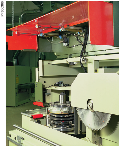
Пример механизма, требующего использования функции безопасности
