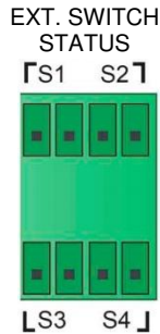
Рисунок 4-8: сухие контакты состояния внешних выключателей
