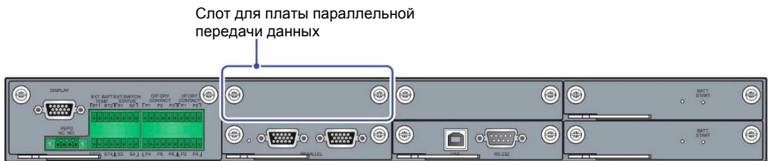
Рисунок 4-12: расположение слота для платы параллельной передачи данных
