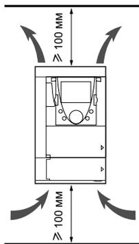
Преобразователь устанавливается в вертикальном положении  $\pm 10^\circ$ .
