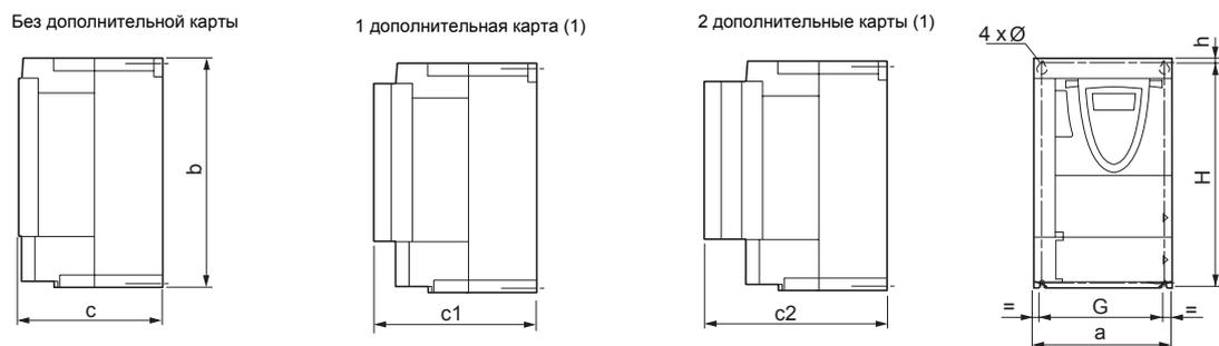
Без графического терминала размеры c, c1 и c2 в верхней таблице уменьшаются на 26 мм, другие размеры остаются неизменными.
