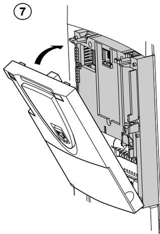
⑦ Установите на место лицевую поверхность управляющей части ПЧ (те же действия, что и при установке дополнительной карты, см. ⑤ и ⑥)
