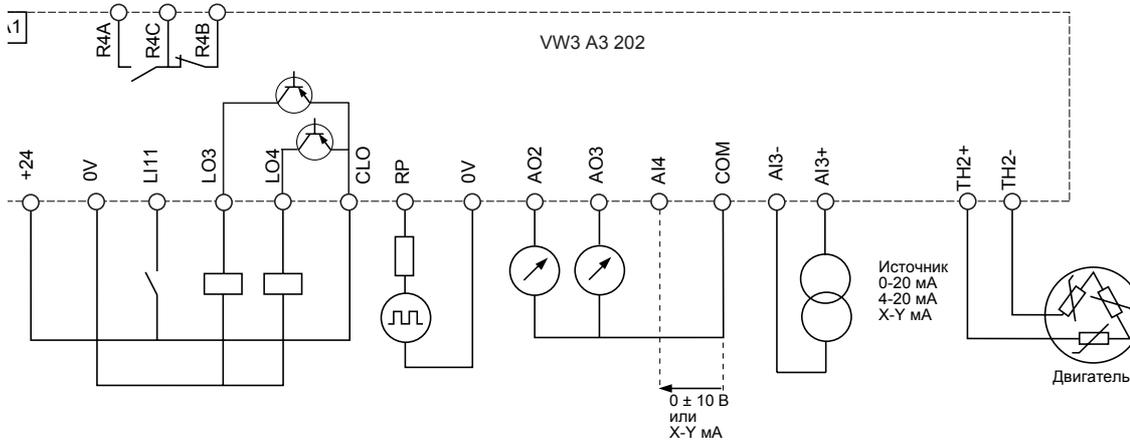
Схема подключения карты дискретных входов-выходов (VW3 A3 201)
