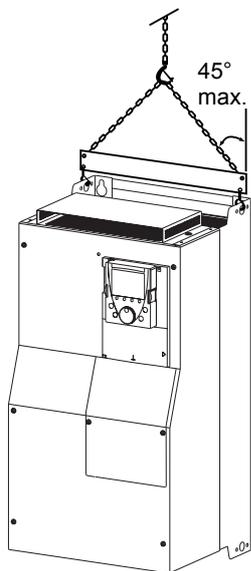
Преобразователи ALTIVAR 61 до типоразмеров ATV61HD15M3X и ATV61HD18N4 могут быть распакованы и установлены без вспомогательных средств.
