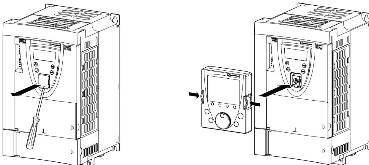
Графический терминал может устанавливаться и сниматься под напряжением. Перед его снятием необходимо отключить функцию управления ПЧ с помощью терминала (обратитесь к руководству по программированию).
