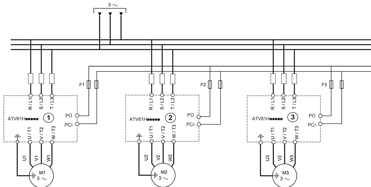
Преобразователи ①, ② и ③ не должны различаться больше, чем на один типоразмер, при таком способе подключения.
