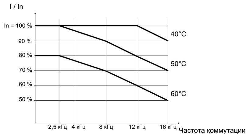
Для промежуточных температур, (например, 55 °C) интерполируйте значение между двумя кривыми.
