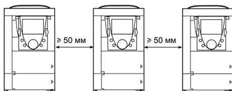
**Способ В** ПЧ со снятыми защитными крышками установлены вплотную друг к другу (степень защиты IP20)
