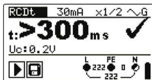
Рисунок 5.4: Пример результатов измерения времени отключения
