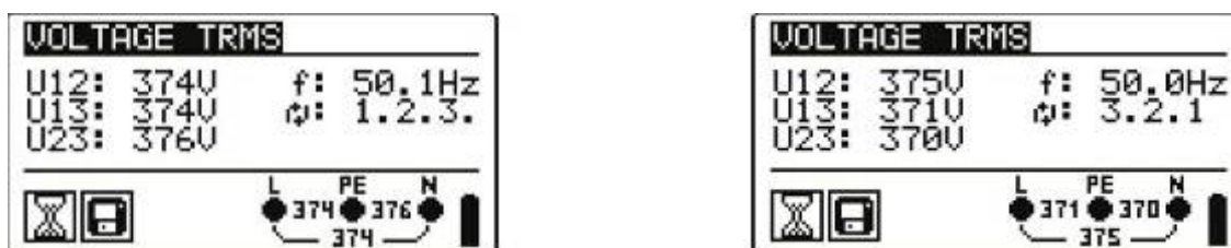
Рисунок 5.17: Примеры измерения напряжения в трехфазной цепи
