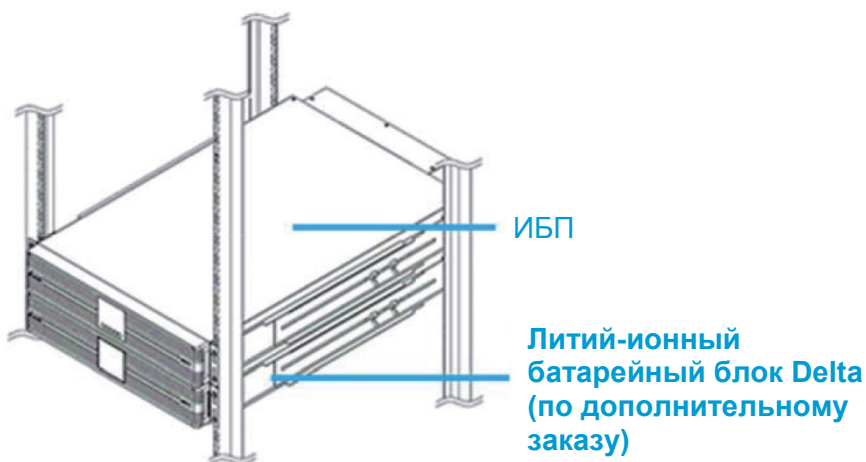
Рисунок 6-6. Установка ИБП в стойку с одним литий-ионным батарейным блоком Delta
