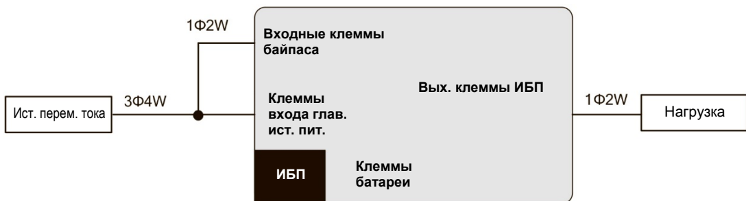
Рисунок 7-4. Схема проводки ИБП. Однофазный выход и вход от одного источника питания
