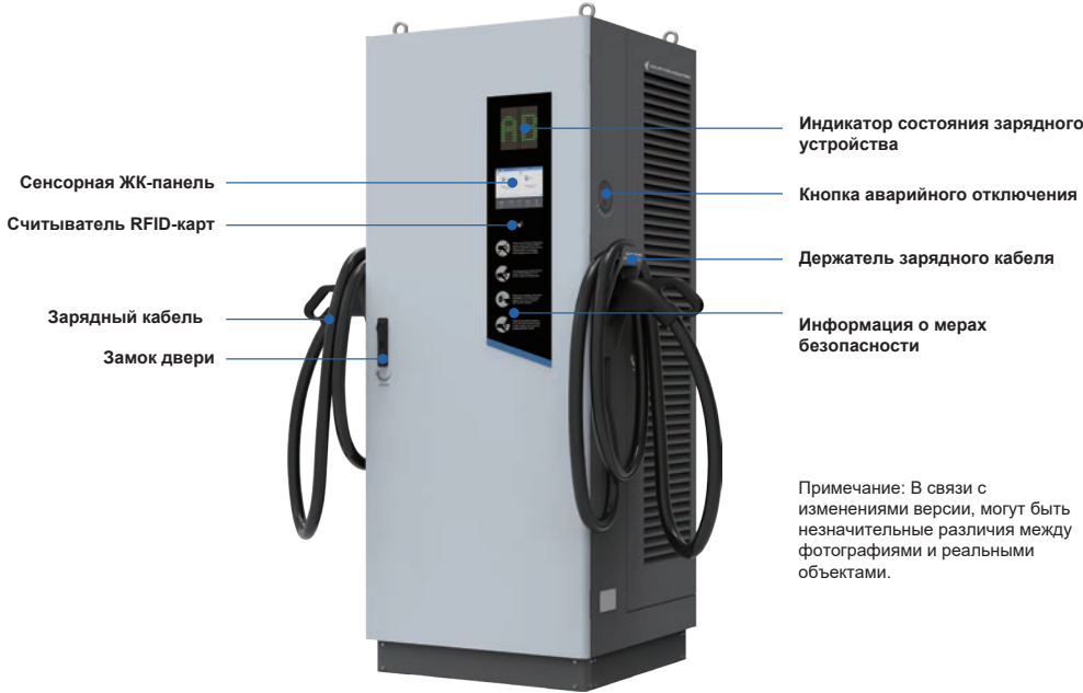
Расположение основных компонентов
