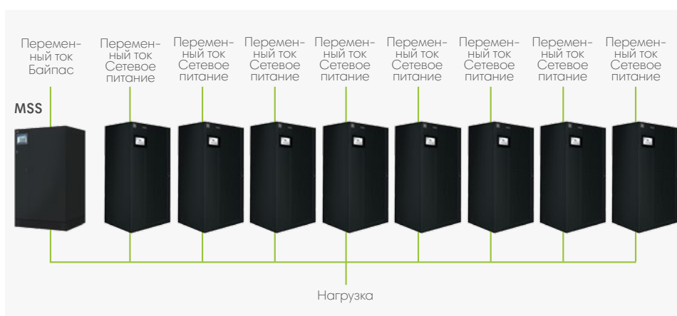
Централизованная параллельная конфигурация ИБП Liebert EXL с главным статическим переключателем (MSS), состоящая из 8 параллельных ИБП
