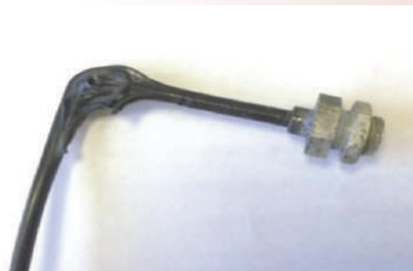
Рис.5 Полимерный ВОД после локализации КРУ, сохранивший работоспособность
