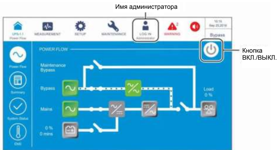
Рисунок 6-41: Главный экран: расположение кнопок имени администратора и ВКЛ./ВЫКЛ.
