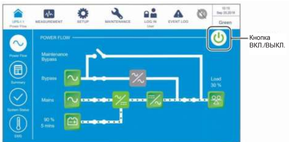
Рисунок 6-62: Экран энергосберегающего режима и кнопка ВКЛ./ВЫКЛ.
