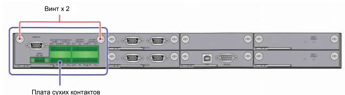
Рисунок 4-5: Расположение платы сухих контактов
