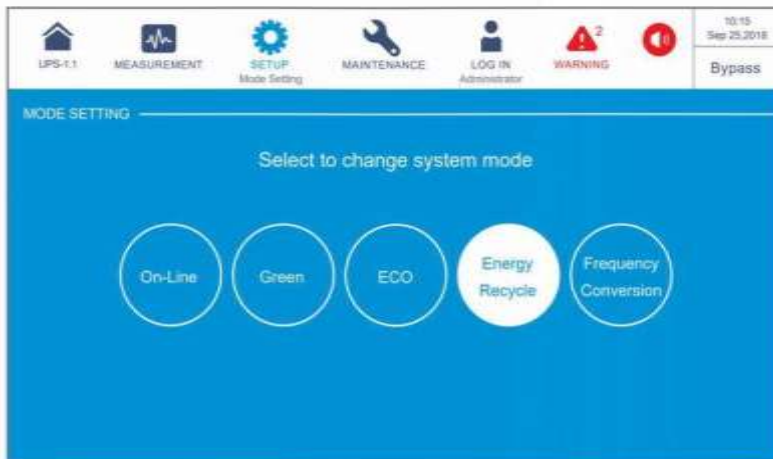
Рисунок 6-42: Выбор режима повторного использования электроэнергии
