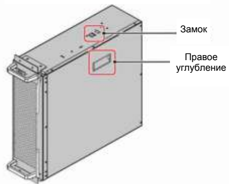
Рисунок 5-30: Расположение замка и боковых углублений
