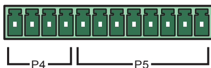
Рис. 4-7. Сухие контакты батареи
