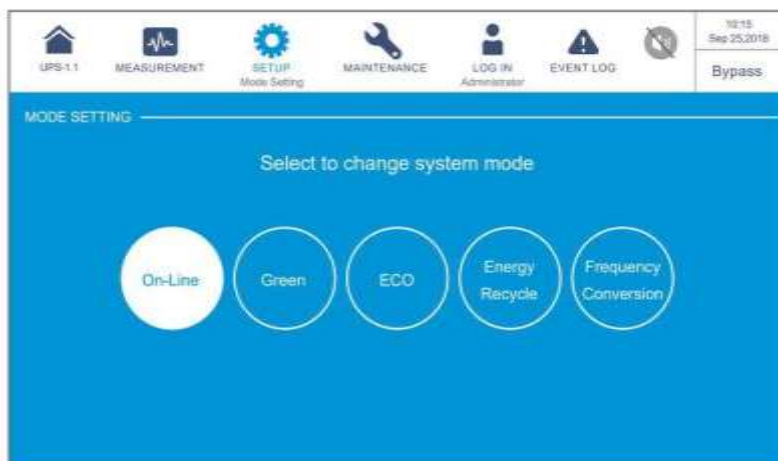
Рисунок 6-71: Выбор режима двойного преобразования
