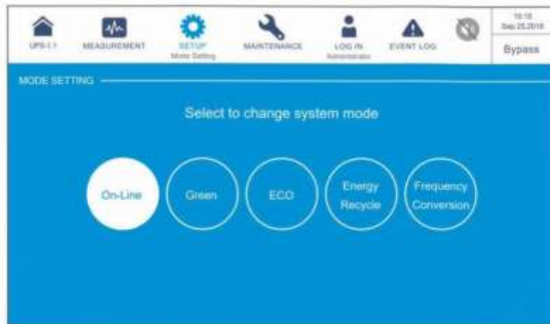
Рисунок 6-66: Выбор режима двойного преобразования
