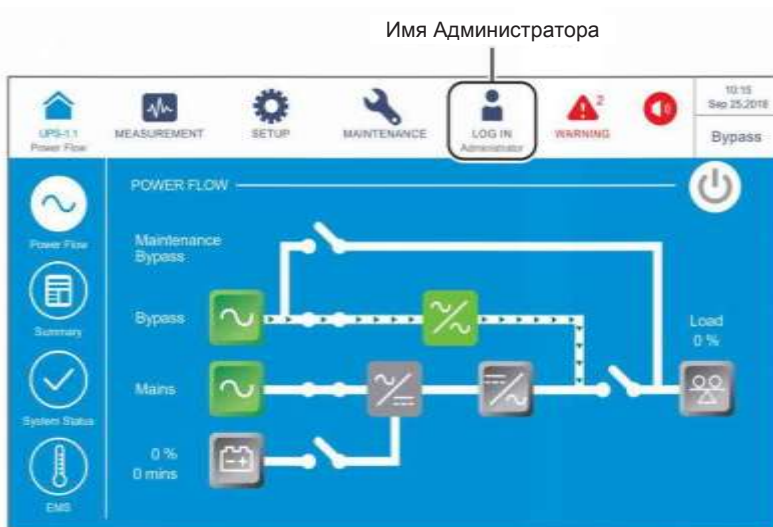
Рисунок 6-70: Экран байпасного режима и имя администратора
