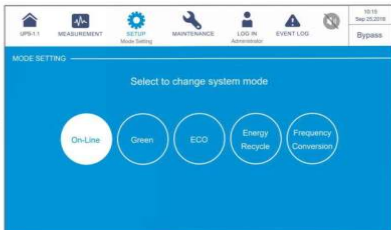
Рисунок 6-61: Выбор режима двойного преобразования
