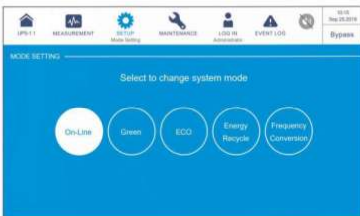
Рисунок 6-56: Выбор режима двойного преобразования
