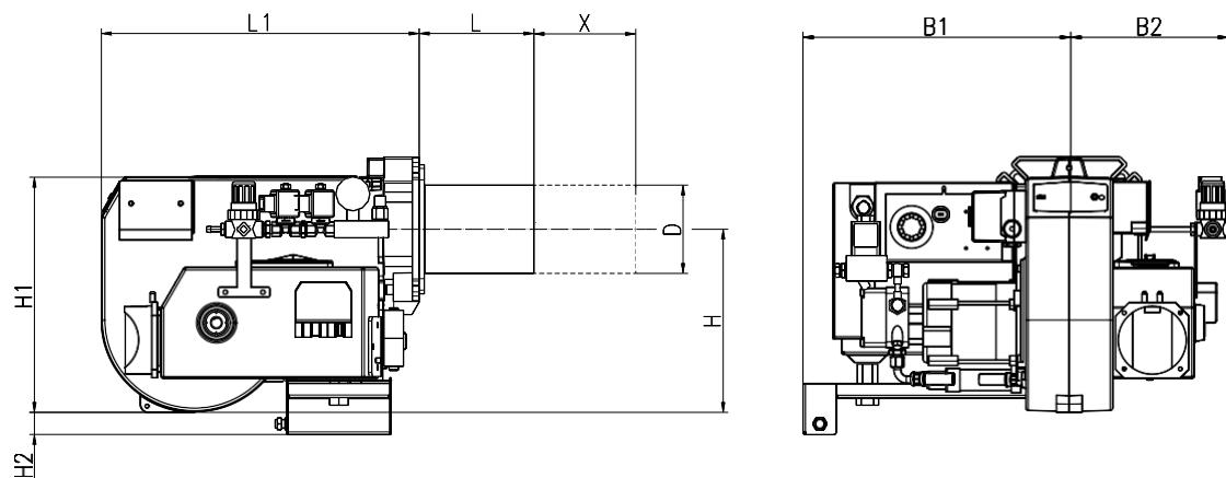
Удлинение горелочной трубы X
