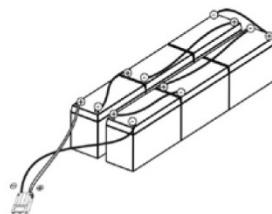
Подключите клеммы батарей по указанной схеме.
