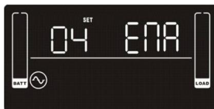
**Параметр 2:** включение или отключение обнаружения неисправностей подключения ИБП. Можно выбрать одну из опций:
