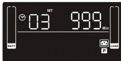
**Параметр 2:** настройка времени резервного питания от программируемых выходных разъемов.
