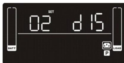
**Параметр 2:** включение или отключение программируемых выходных разъемов.
