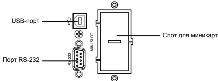
Чтобы обеспечить автоматическое выключение/запуск и контроль состояния ИБП, подключите один конец коммуникационного кабеля к порту USB/ RS-232, а другой – к коммуникационному порту ПК. С установленным программным обеспечением мониторинга вы можете запланировать выключение/запуск ИБП и контролировать его состояние через ПК.
