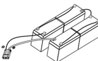
Подключите клеммы батарей по указанной схеме.
