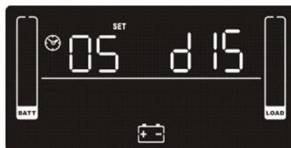
**Параметр 2:** настройка времени резервного питания в режиме работы от батареи через выходы общего назначения.
