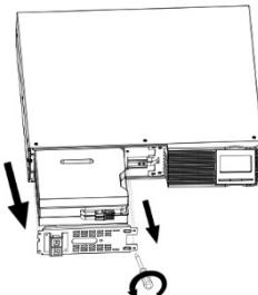
Вытяните батарейный отсек, открутив два винта на передней панели.
