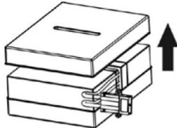
Снимите верхнюю крышку батарейного отсека и замените батареи.
