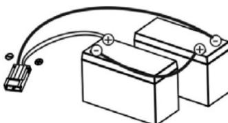
Подключите клеммы батарей по указанной схеме.
