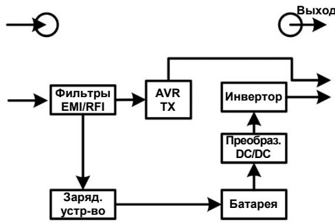
ИБП состоит из сетевого входа, фильтров электромагнитных помех EMI/RFI, инвертора, зарядного устройства батареи, преобразователя постоянного тока в постоянный (DC/DC), батареи, выхода AVR TX автоматической стабилизации напряжения (ACН) и выхода ИБП.
