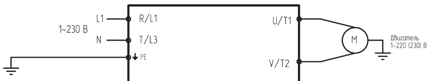
Подключение силовых клемм для моделей LCI-GY/PY-1
