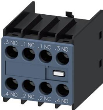
Вспомогательный выключатель с лицевой стороны, 2 NO + 2 NC Токопровод 1 HO, 1 H3, 1 H3, 1 HO для 3RH2 и 3RT2 Винтовой зажим .3/.4, .1/.2, .1/.2, .3/.4
