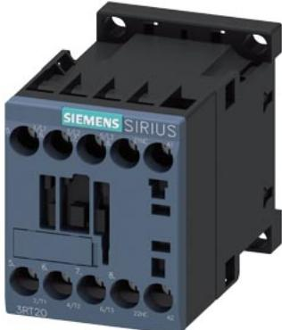
Силовой контактор, AC-3 9 A, 4 кВт/400 В 1 НЗ, 110 В AC, 50 / 60 Гц 3-полюсн., типоразмер S00, винтовой зажим
