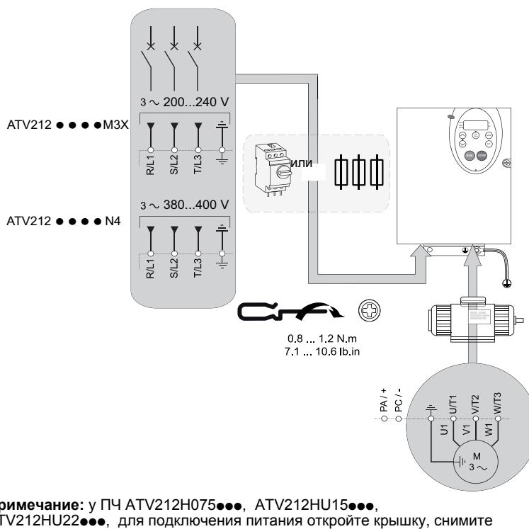
**Примечание:** у ПЧ ATV212H075●●●, ATV212HU15●●●, ATV212HU22●●●, для подключения питания откройте крышку, снимите коммуникационный модуль, подключите R/L1, S/L2, T/L3 и поставьте на место коммуникационный модуль.
