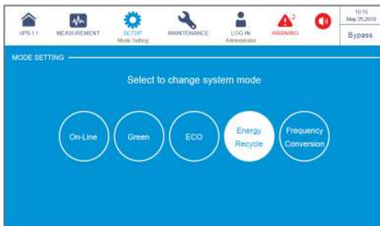
Рисунок 6-42: Выбор режима повторного использования электроэнергии
