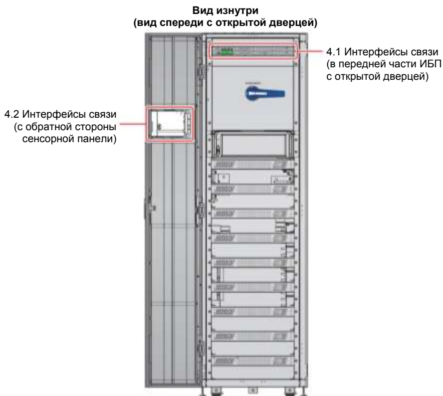
Рисунок 4-1: Расположение интерфейсов связи
