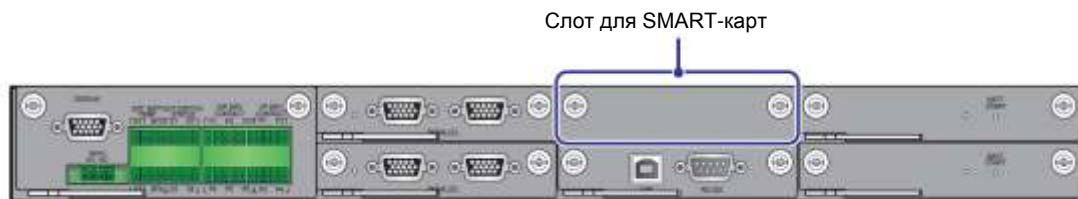
Рисунок 4-12: Расположение слота для SMART-карт
