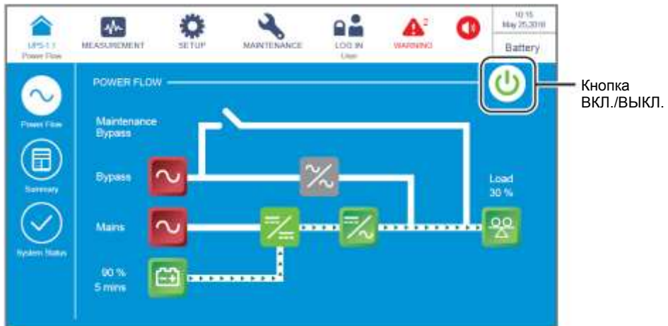
Рисунок 6-48: Экран батарейного режима и кнопка ВКЛ./ВЫКЛ.
