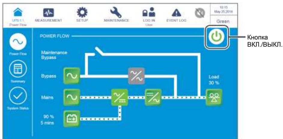
Рисунок 6-62: Экран энергосберегающего режима и кнопка ВКЛ./ВЫКЛ.
