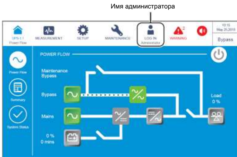
Рисунок 6-70: Экран байпасного режима и имя администратора
