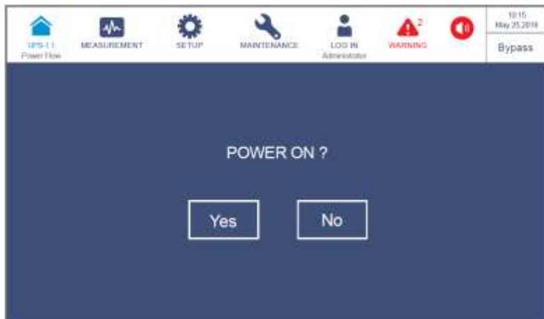
Рисунок 6-43: Экран с запросом о включении
