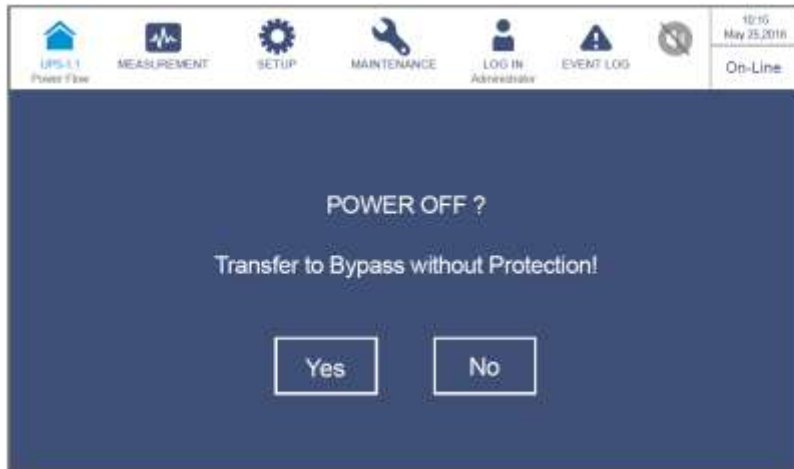
Рисунок 7-7: Окно с запросом о выключении питания
