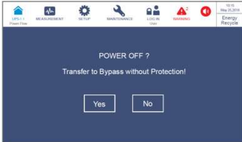
Рисунок 6-68: Экран с запросом об отключении
