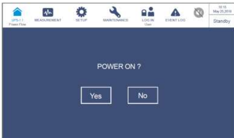
Рисунок 6-8: Экран с запросом о включении
