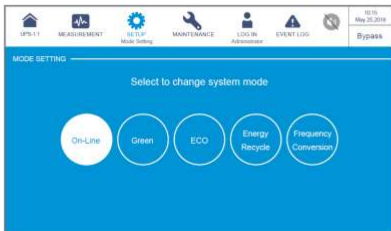
Рисунок 6-56: Выбор режима двойного преобразования
