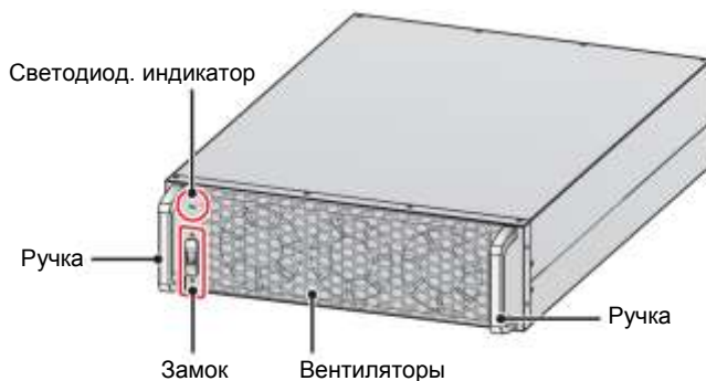
Рисунок 5-37: Силовой модуль (опция)
