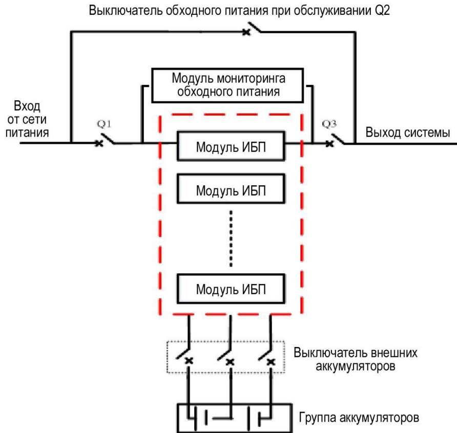
Рис. 2-1. Функциональная схема ИБП
