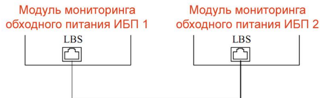
Рис. 1-20. Схема соединения LBS
