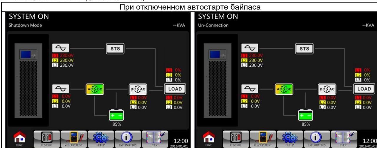
ИБП перейдет в режим отключения
