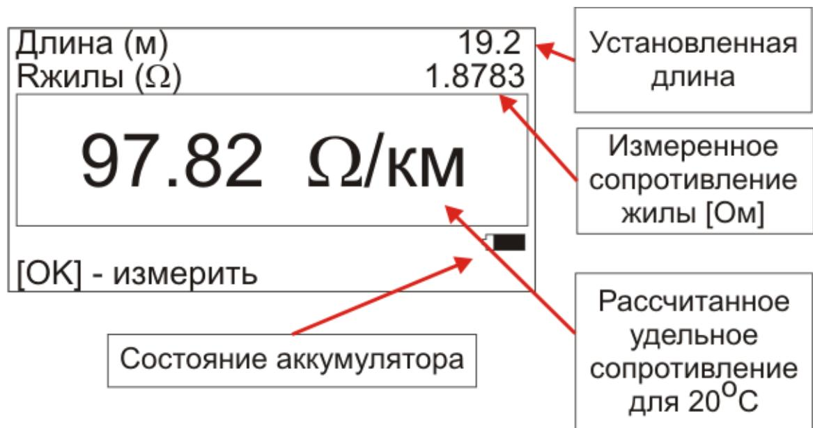
Прибор запускает измерение по кнопке
