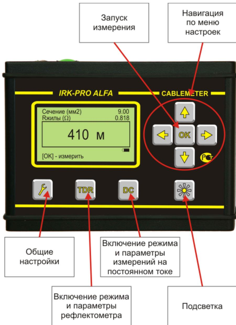
Кнопки на передней панели управляют работой прибора.
