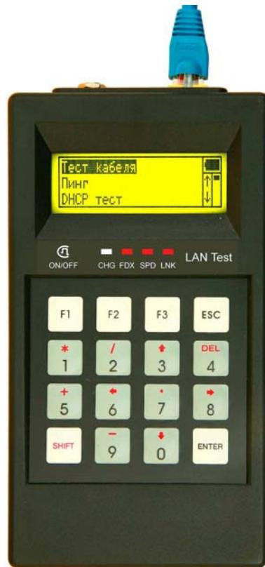
При тестировании медных кабелей для Ethernet полезен прибор LAN Test
