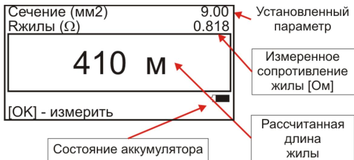
Прибор запускает измерение по кнопке
